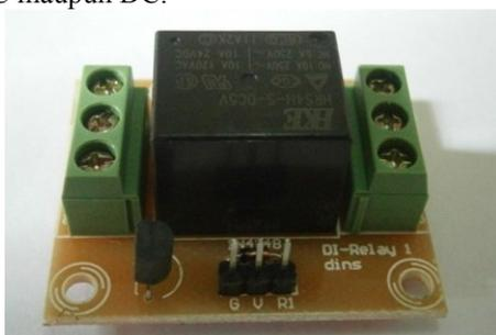
Gambar 6. Modul DI-Relay 1
