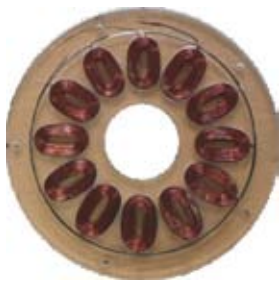
Gambar 12. Konstruksi stator generator dengan 12 lilitan kumparan
