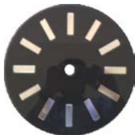
Gambar 13. Konstruksi rotor generator dengan 12 kutub magnet permanen
