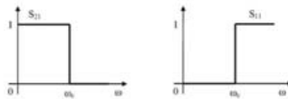
Gambar 2.2 Kiri: karakteristik refleksi ideal dari filter lolos bawah, kanan: karakteristik transmisi ideal dari filter lolos bawah
