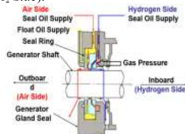
Gambar 5. Konstruksi Gland Seals
