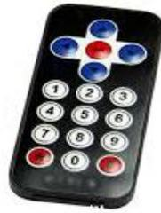
Gambar 6. Remote control berbasis inframerah
