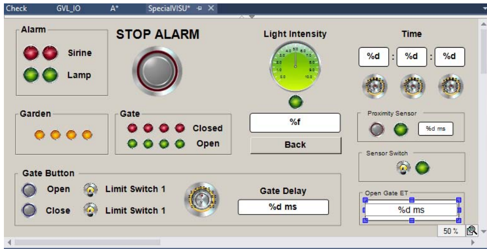
Gambar 10. Tampilan HMI simulasi sistem keamanan bangunan
