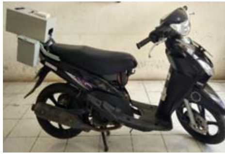
Gambar 5 Pemasangan full box sistem genset pada bagasi sepeda motor
