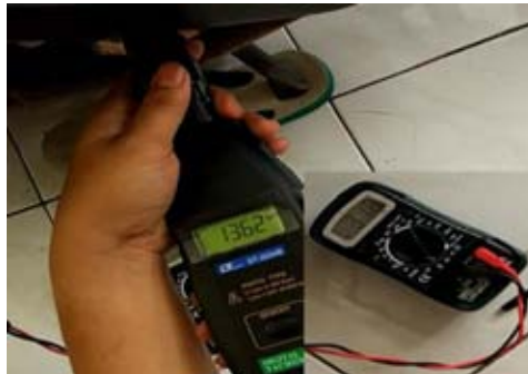
Gambar 6 Pengukuran kecepatan terhadap tegangan alternator
