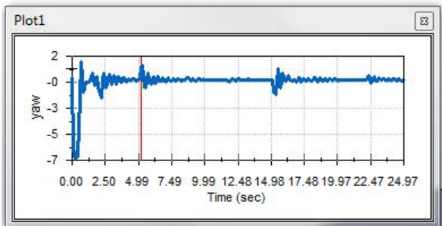
Gambar 9: Yaw pada titik berat kendaraan (simulasi dinamik)
