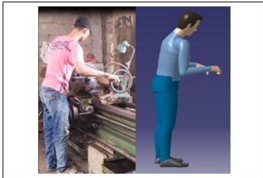
Gambar 4. *Mannequin* Operator Pembubutan
