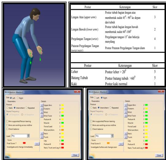
Gambar 4. Postur kerja Operator 2 dan hasil software Catia V5 pada proses mengarahkan produk roof
