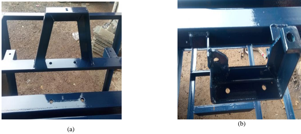
Figure 10. Stand making, (a) Turbine actual stand, (b) Generator actual stand
