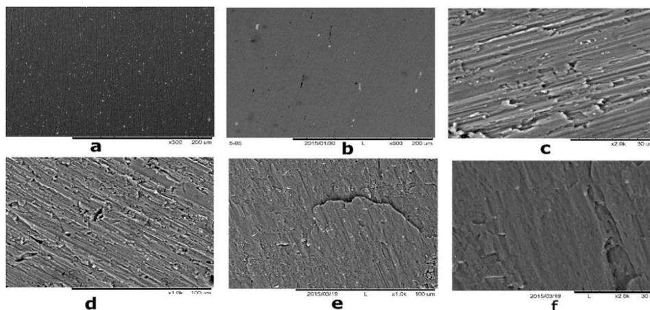
Figure 3. ARB results (a) AA1070 (b) AA7075 (c) AA1070/Al<sub>2</sub>O<sub>3</sub> (d) AA1070/B<sub>4</sub>C (e) AA7075/Al<sub>2</sub>O<sub>3</sub> (f) AA7075/B<sub>4</sub>C.
