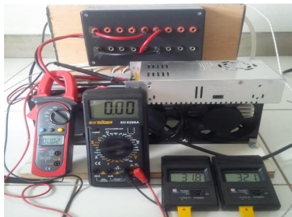
Gambar 5. Pengujian dengan Mengukur Suhu Heatsink ( Step 1 )
