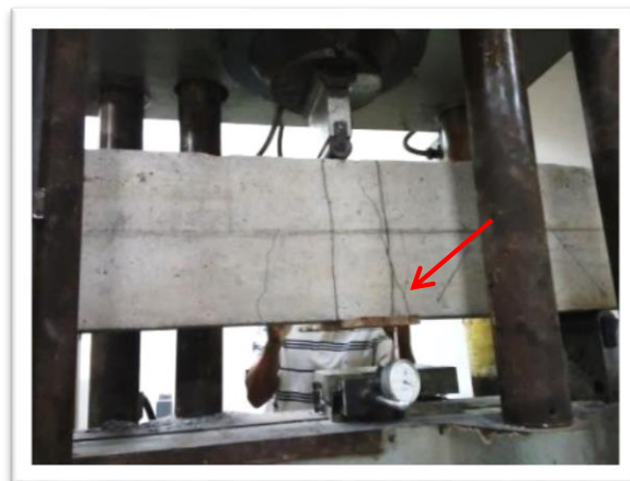
Gambar 3. Pelaksanaan pengujian kuat lentur balok LS
