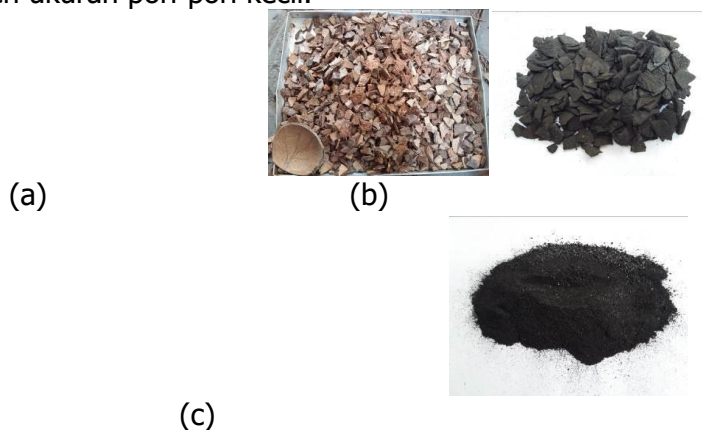
Gambar 1. Tempurung Kelapa (a) sebelum diarangkan (b) setelah diarangkan (c) setelah dihaluskan
