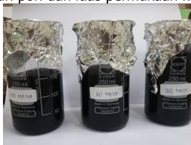
Gambar 2. Proses Aktivasi Arang Tempurung Kelapa Menggunakan Larutan Asam Fosfat
