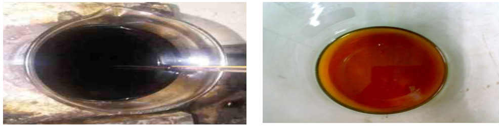
(a) Gambar 6. Minyak nyamplung a. Minyak nyamplung kasar b. Minyak nyamplung setelah degumming
