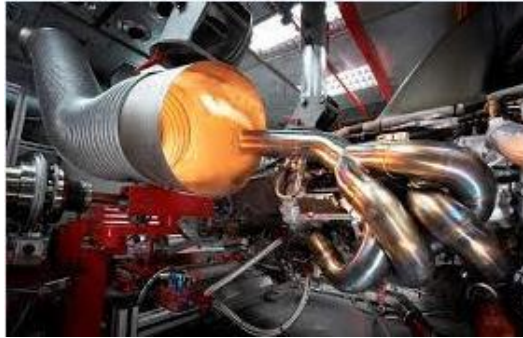
Gambar 6. Pengujian prestasi mesin dengan alat test dynamometer [10].
