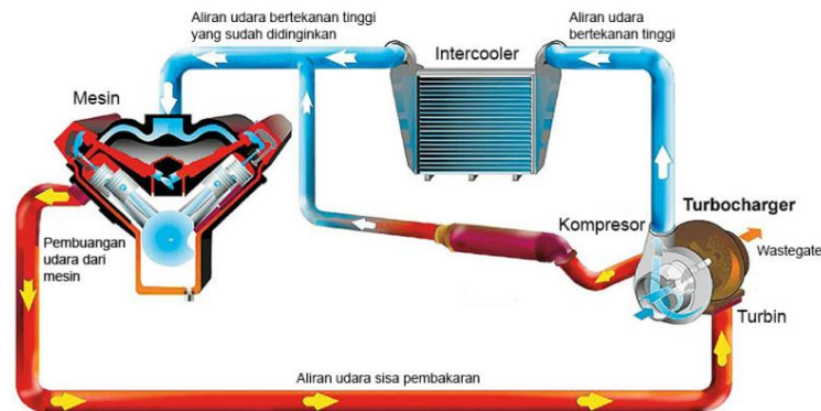
Gambar 4. Skema turbocharger pada mesin diesel [6].
