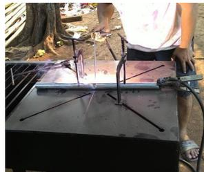
Gambar 20 Pengelasan posisi *down hand*
