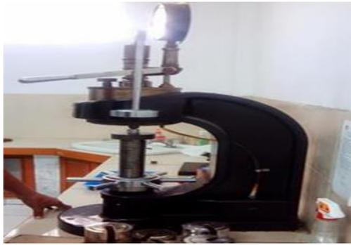
Gambar 3. Mesin uji kekerasan Vickers.
