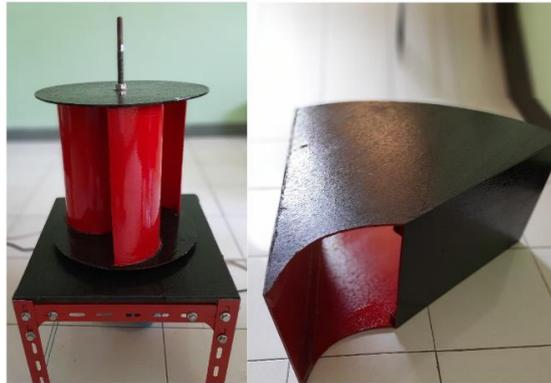
Gambar 4. Turbin savonius 3 sudu dan pengarah angin.
