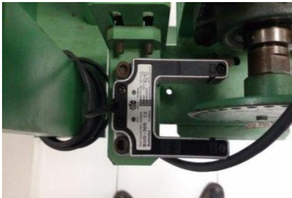
Gambar 18. BUD – 30S photosensor dan encoder disk.
