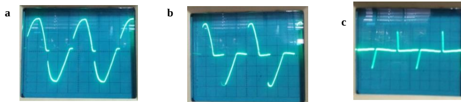
Gambar 5. Hasil Pengujian AC-AC Voltage Controller (a) Penyulutan 25° (b) Penyulutan 81° (c) Penyulutan 167°
