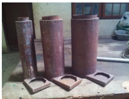
Gambar 1. Sketsa tungku gasifikasi Tipe Down-draft dan tungku gasifikasi model "Castle" dengan diameter berbeda
