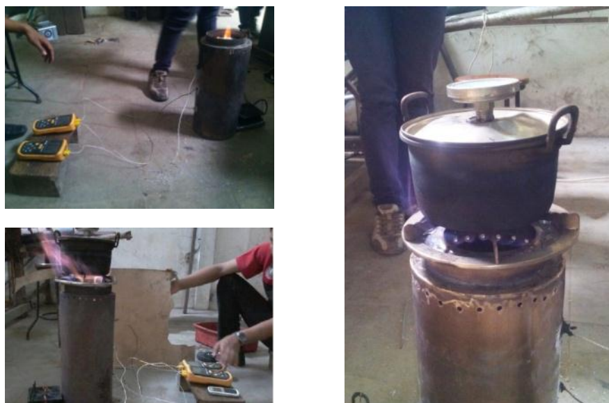
Gambar 2. Water boiling test tungku gasifikasi
