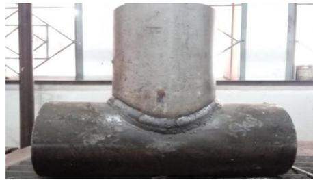
**Gambar 16. Permukaan lasan sebelum proses *brushing***
