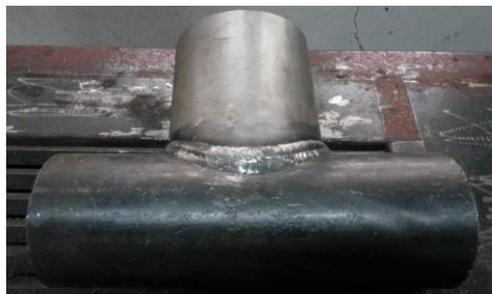
**Gambar 17. Permukaan lasan setelah proses *brushing***
