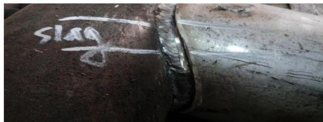
**Gambar 13. Hasil proses *rooting* serta hasil cacat buatan pada spesimen *T joint***
