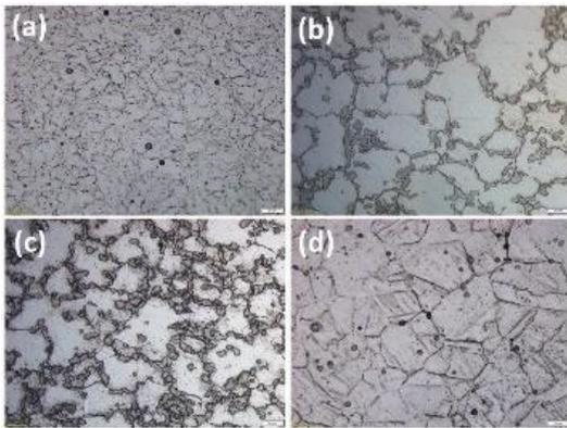
**Figure 1.** Micro structure of AISI 4340 Steel (a) Without treatment. (b) Holding time 40 min. (c) Holding time 80 min. (d) Holding time 120 min
