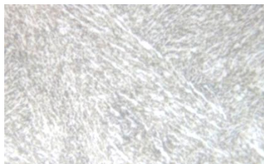
Gambar 8. Hasil metalografi permukaan AISI 4130 Low Alloy Steel hasil hardening pada suhu 800 °C dan telah melewati proses tempering pada suhu 400 °C, 500 °C, dan 600 °C. Dari fasa martensite (L84) menjadi ferrite-spheroid sementit (L85), lalu muncul sedikit fasa martensite (L86).
