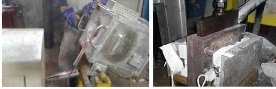
**Gambar 4.** Proses penuangan dan penekanan material coran
