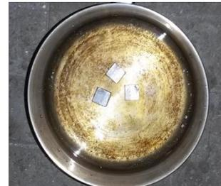
**Gambar 8.** Proses *quenching* menggunakan air
