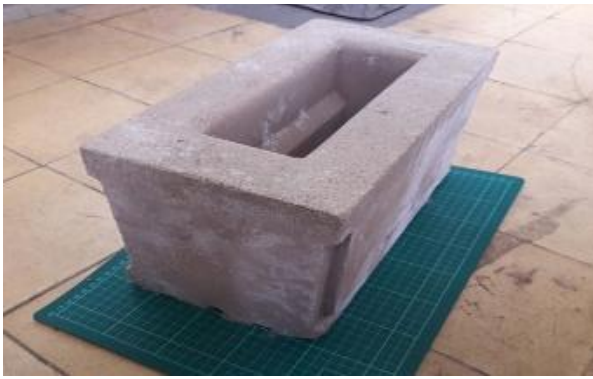
Gambar 4. Bentuk cetakan pasir yang siap untuk digunakan.
