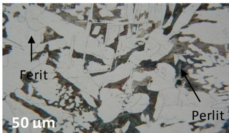
**Gambar 15.** Struktur mikro sampel *As Cast* dengan 500 kali perbesaran.
