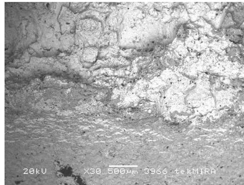
**Gambar 28.** Struktur patahan sampel media *quenching* udara perbesaran 30 kali
