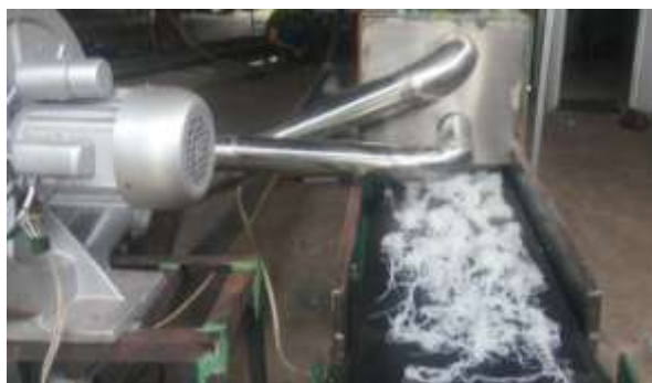
Gambar 4. Proses pengeringan pada mesin pengering hybrid tipe konveyor otomatis
