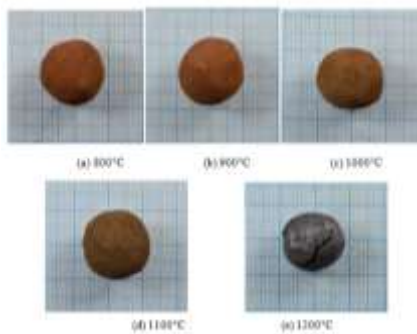
Gambar 6. Penampakan Sampel Pelet Debu Pabrik Feronikel Dengan Variasi Temperatur Waktu=60 menit
