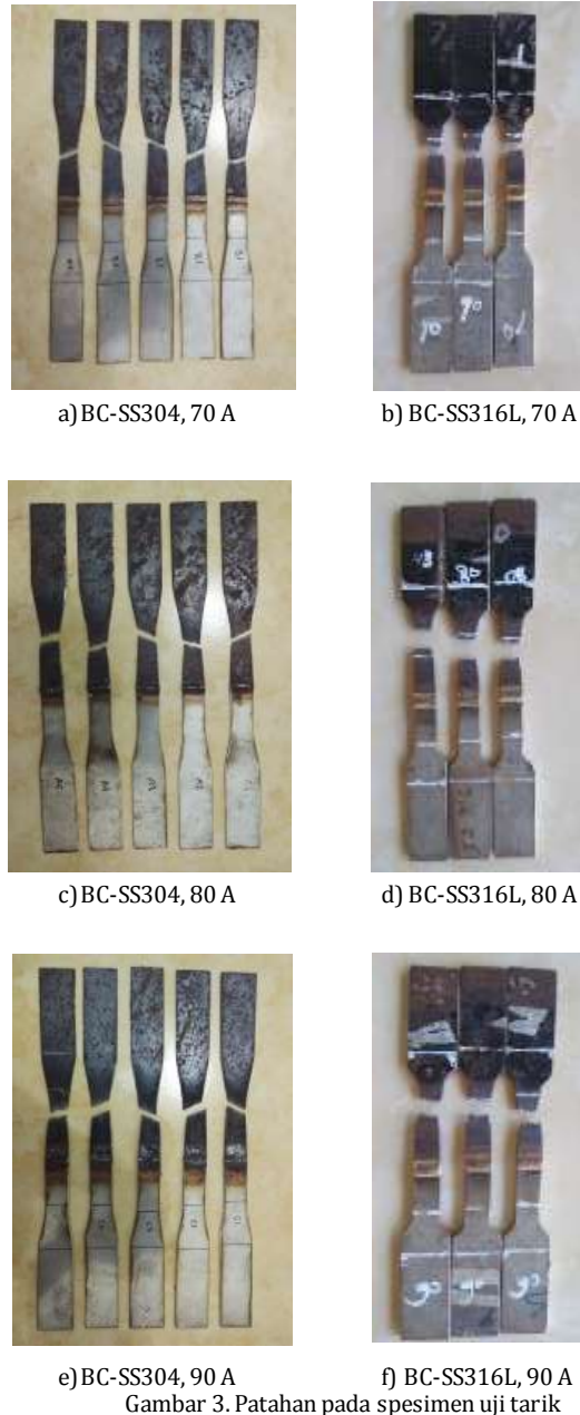
Gambar 3. Patahan pada spesimen uji tarik
