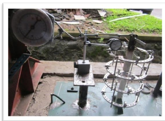
Gambar 5. Uji lendut 4 ring
