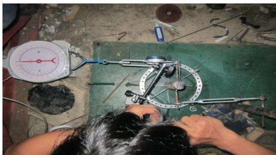
Gambar 15. Uji Puntir 1 Ring
