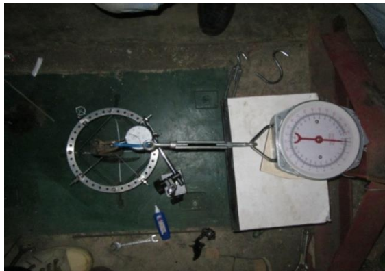
Gambar 13. Uji Lendut 1 ring
