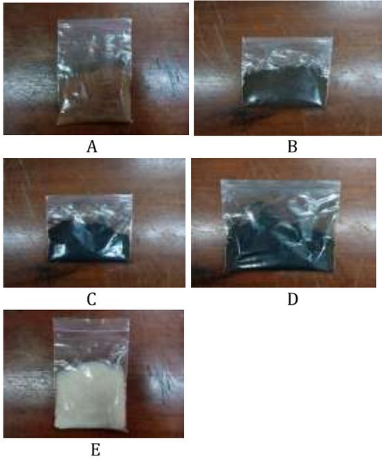
**Gambar 4.** Hasil Rancang bangun Alat Torefaksi Sampel Nasi A.) T. 210°C, B) T.240°C, C). T.270°C D). T.300°C E).Nasi Non Torefaksi
