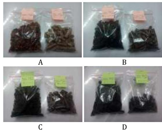
**Gambar 3.** Hasil Rancang bangun Alat Torefaksi A.) T. 210°C, B) T.240°C, C). T.270°C D). T.300°C
