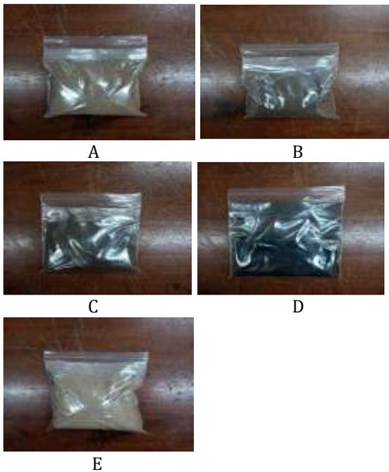
**Gambar 5.** Hasil Rancang bangun Alat Torefaksi Sampel Kayu A.) T. 210°C, B) T.240°C, C). T.270°C D). T.300°C E).Kayu Non Torefaksi
