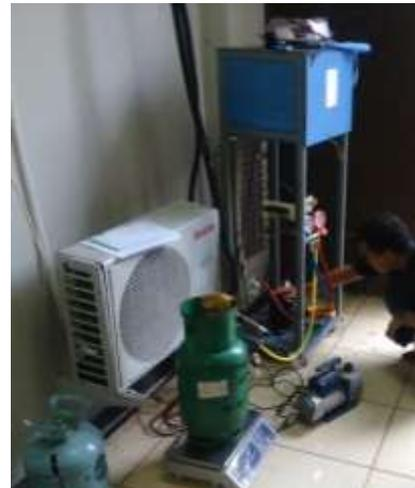
**Gambar 1** Pengujian retrofit refrigeran R-134a dengan MC-22 pada mesin pendingin refrigerator
