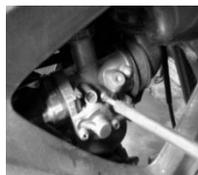
**Gambar 5. Penyetelan Gas Pada Karburator**
