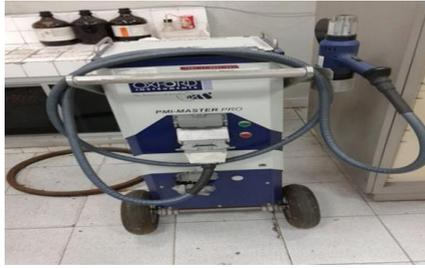
**Gambar 2.** Alat Uji Komposisi PMI (*Positive Material Identification*)
