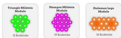
**Gambar 6.** Tiga teknik dasar dalam menyusun *eco-brick* yaitu bentuk segitita (kiri), bentuk heksagonal (tengah), dan bentuk bongkar pasang (kanan).
