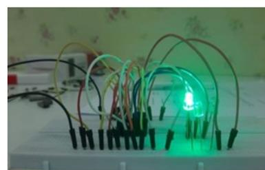
**Gambar 30.** Rangkaian komparator input  $0100_2$  dan  $0000_2$
