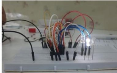
**Gambar 32.** Rangkaian komparator input  $1111_2$  dan  $1111_2$
