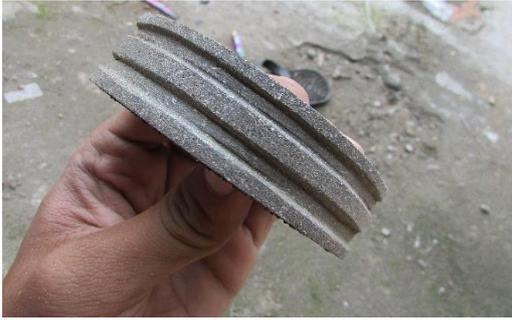
Gambar 4. Kampas rem tromol dengan alur searah putaran roda (sumber: Dokumentasi Pribadi)
