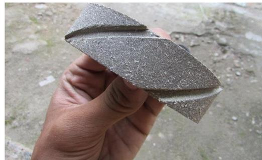
Gambar 3. Kampas rem tromol dengan alur miring (sumber: Dokumentasi Pribadi)
