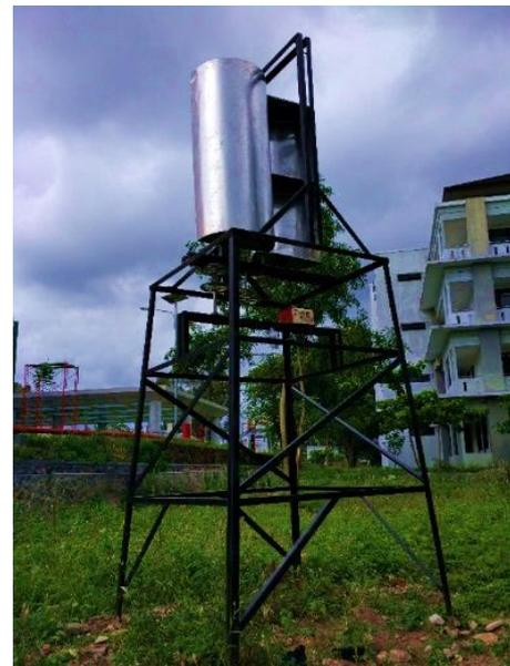
Gambar 6. Turbin angin Savonius dipasang pada lokasi pengujian
