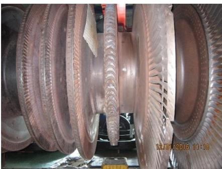
Gambar 3. Bagian *blade* setelah dipotong
