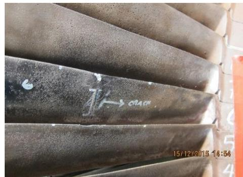
Gambar 4. Bagian *blade* yang terkena crack
